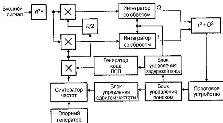
Рис. 1 Упрощенная схема обработки сигналов и извлечения навигационной информации
