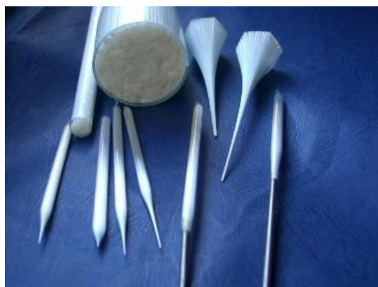
Фото 6. Различные матрицы из поликапилляров и аккумуляторы на их основе.
