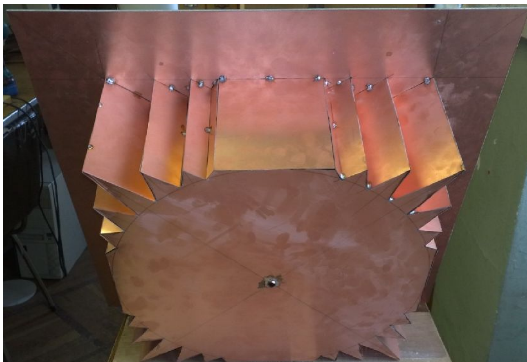
Рис. 3. Конструкция резонатора ELS спиральной антенны
