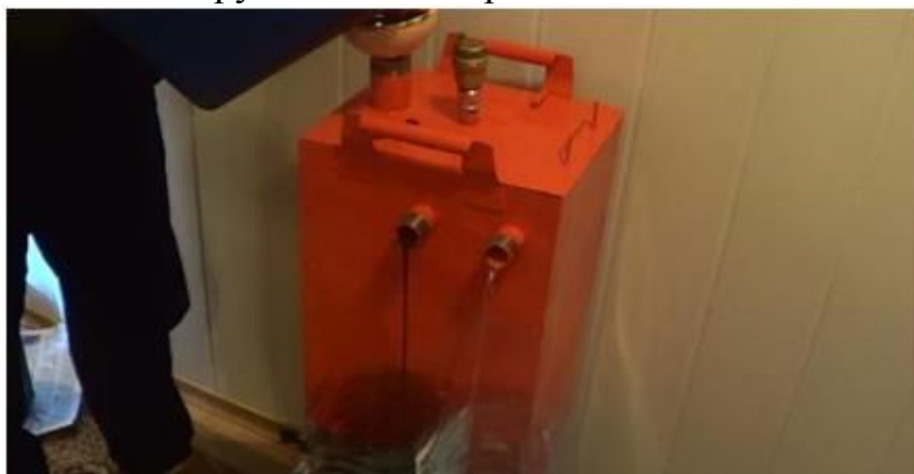
Непрерывное разделение водо-нефтяной эмульсии.
