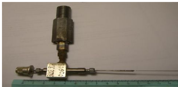
Фото 5. Миниатюрная система заполнения матрицы водородом.
