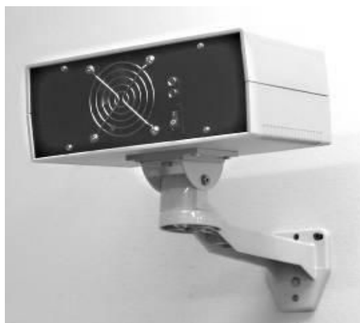
Рис. 2. Внешний вид макета прибора для систем пожарно-охранной сигнализации и мониторинга воздушной среды.
